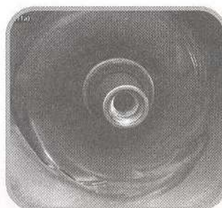
شکل ۱۱- a: آسیب عمده ناشی از خوردگی - سایشی بر روی قطعه سرپوش رانش پوشش داده نشده پمپ ۳۱۵-۱۲۵ بعد از پوشش دهی با ARCMX۲ بر روی قطعه‌های رانش (B) نشانگر آسیب جزئی بعد از ۶۴۷۴ ساعت کار کرد میباشد.
