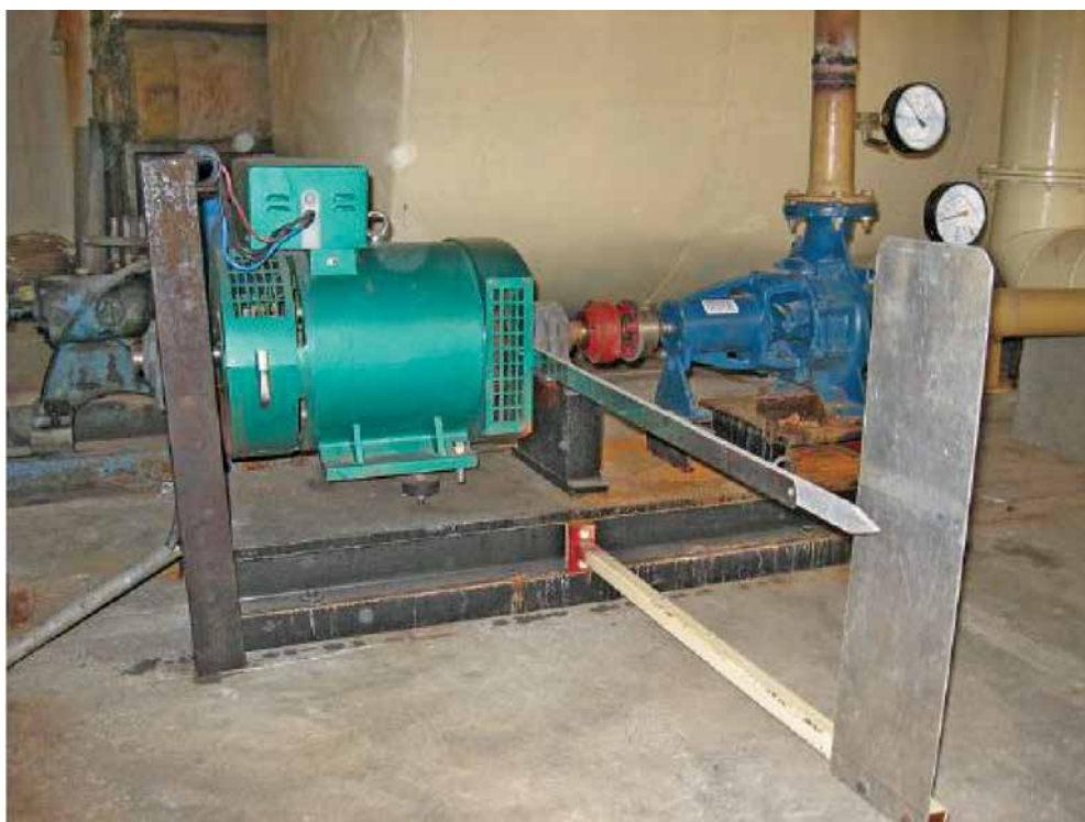
شکل ۲- روش اندازه گیری گشتاور شفت یک PAT
