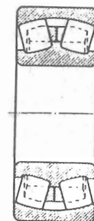
تصویر شماره ۲۱: نمایش مقطع عرضی یک رولربرینگ دو ردیفه از نوع خود میزان
