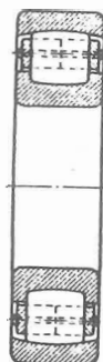
تصویر شماره ۱۹: نمایش مقطع عرضی یک رولر برینگ از نوع خود میزان
