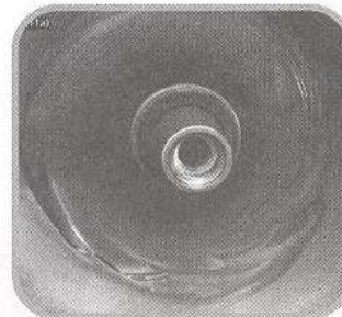
شکل ۱۱-ا: آسیب عمده ناشی از خوردگی - سایشی بر روی قطعه سرپوش رانش پوشش داده نشده پمپ ۳۱۵-۱۲۵ بعد از پوشش دهی با ARCMX۲ بر روی قطعه‌های رانش (B) نشانگر آسیب جزئی بعد از ۶۴۷۴ ساعت کار کرد میباشد.
