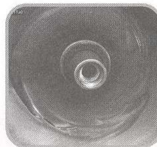
شکل ۱۱-ا: آسیب عمده ناشی از خوردگی - سایشی بر روی قطعه سرپوش رانش پوشش داده نشده پمپ ۳۱۵-۱۲۵ بعد از پوشش دهی با ARCMX۲ بر روی قطعه‌های رانش (B) نشانگر آسیب جزئی بعد از ۶۴۷۴ ساعت کار کرد میباشد.
