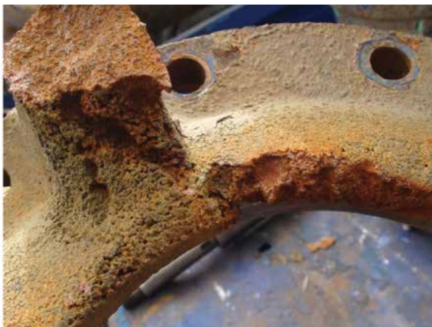
شکل ۲- تخریب قطعه در اثر خوردگی
