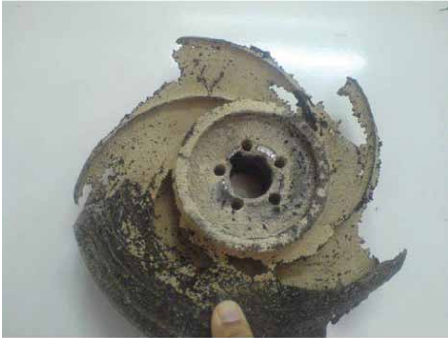
شکل ۳- خوردگی پروانه پمپ
