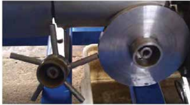
شکل ۱۱: پروانه های مورد استفاده برای آزمایشات تجربی: یک مدل چندلوله ای و یک مدل سوراخ کاری شده
